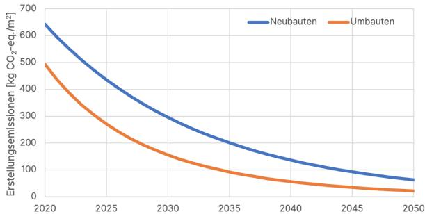
Die Pionier-Studie Priore et al. 2023 der ETH Zürich empfiehlt demnach, die Erstellungsemisionen bei Neubauten bis 2037 im Vergleich zu 2020 um etwa zwei Drittel abzusenken, und bei Umbauten um etwa vier Fünftel.
